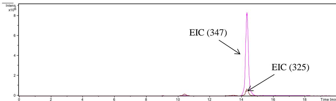
**Slika 16.** EIC kromatogram iona  $m/z$  347 i 325 (sterigmatocistin).
