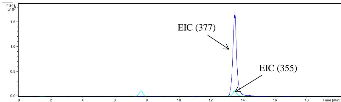
**Slika 15.** EIC kromatogram iona  $m/z$  377 i 355 (5-metoksisterigmatocistin).
