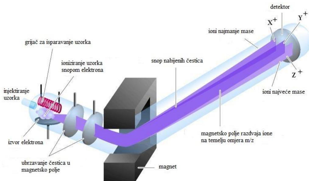
**Slika 3.** Princip rada masenog spektrometra (izvor: <http://www.mhhe.com>)
