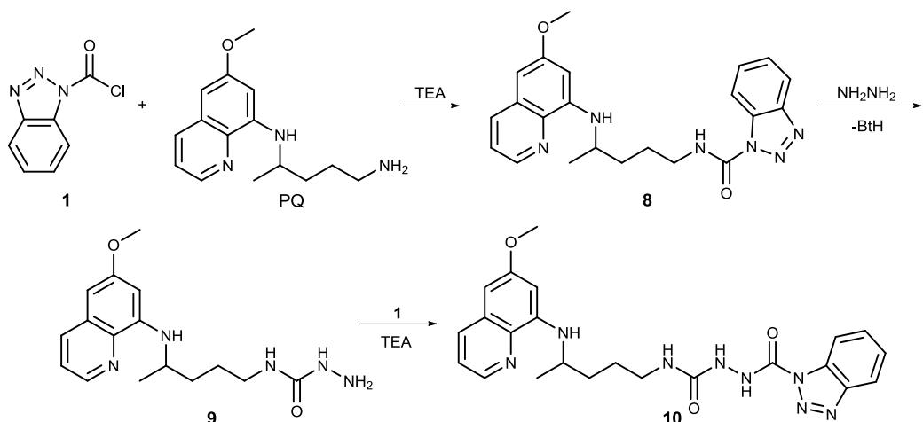
**Shema 29.** Sinteza derivata primakina: semikarbazida **9** i benzotriazolida semikarbazida **10**.
