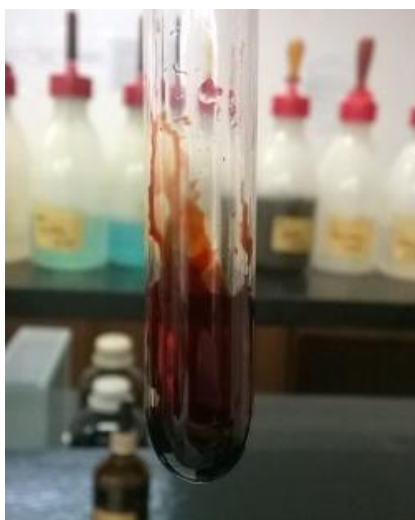
Slika 7. Tamno crveno obojenje \text{Fe}(\text{SCN})_3
