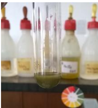
Slika 3. Maslinasti talog Hg 2 CO 3
