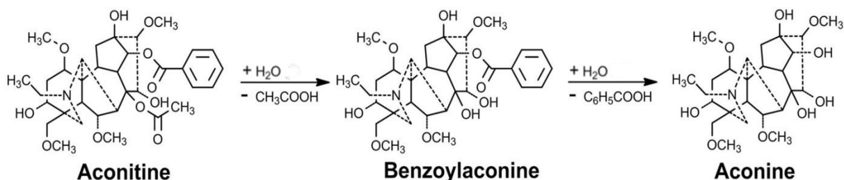
Slika 12. Postupak detoksifikacije akonitina temeljen na hidrolizi u dva koraka
