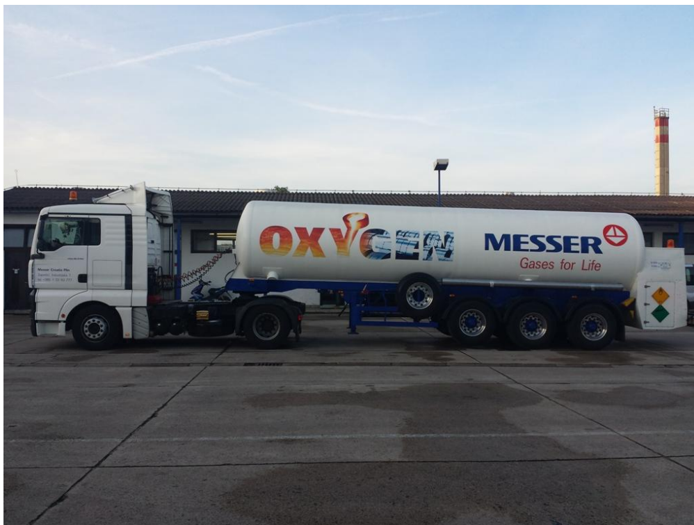
Slika 12: Autocisterna za prijevoz tekućeg medicinskog plina. (vlastita fotografija)
