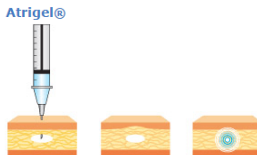
Slika 28. Shematski prikaz Atrigel ® tehnologije ( http://www.qltinc.com/ ).
