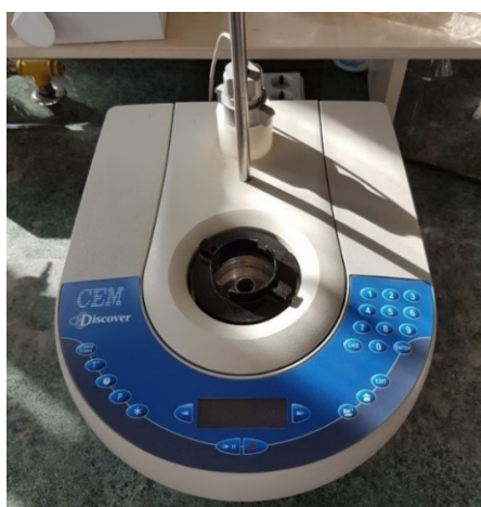
Slika 8. Uređaj za mikrovalnu sintezu u Zavodu za farmaceutsku kemiju i odgovarajući pribor
