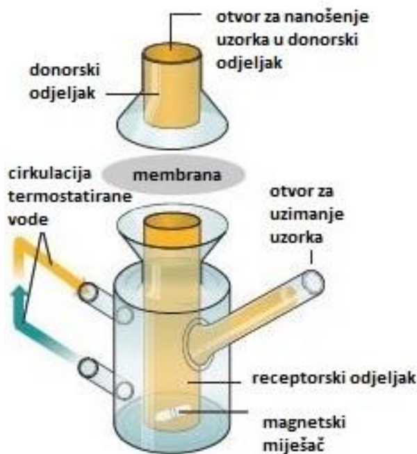
Slika 4. Franzova difuzijska ćelija (prilagođeno prema www.particlesciences.com )
