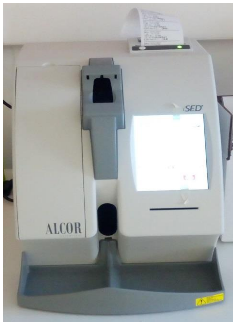
Slika 3. Prikaz automatskog analizatora iSED za određivanje brzine sedimentacije eritrocita (Helena Čičak)
