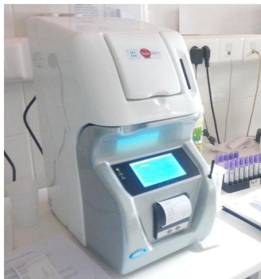
Slika 2. Prikaz automatskog analizatora Roller 20 PN za određivanje brzine sedimentacije eritrocita (Helena Čičak)
