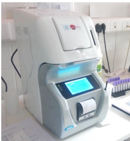
Slika 2. Prikaz automatskog analizatora Roller 20 PN za određivanje brzine sedimentacije eritrocita (Helena Čičak)
