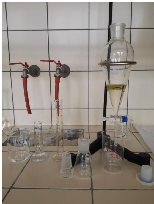
Slika 24. Ekstrakcija acetonskog ekstrakta etil acetatom u lijevku za odjeljivanje.
