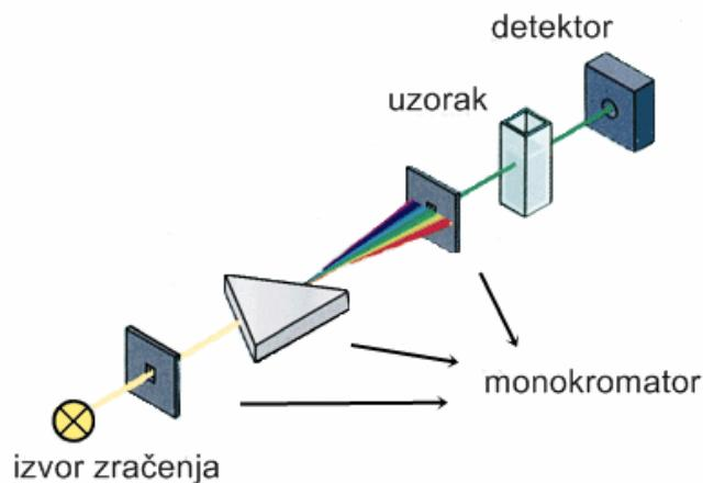
Slika 5. Osnovni dijelovi UV-Vis spektrofotometra (preuzeto od: Gohain, 2008).
