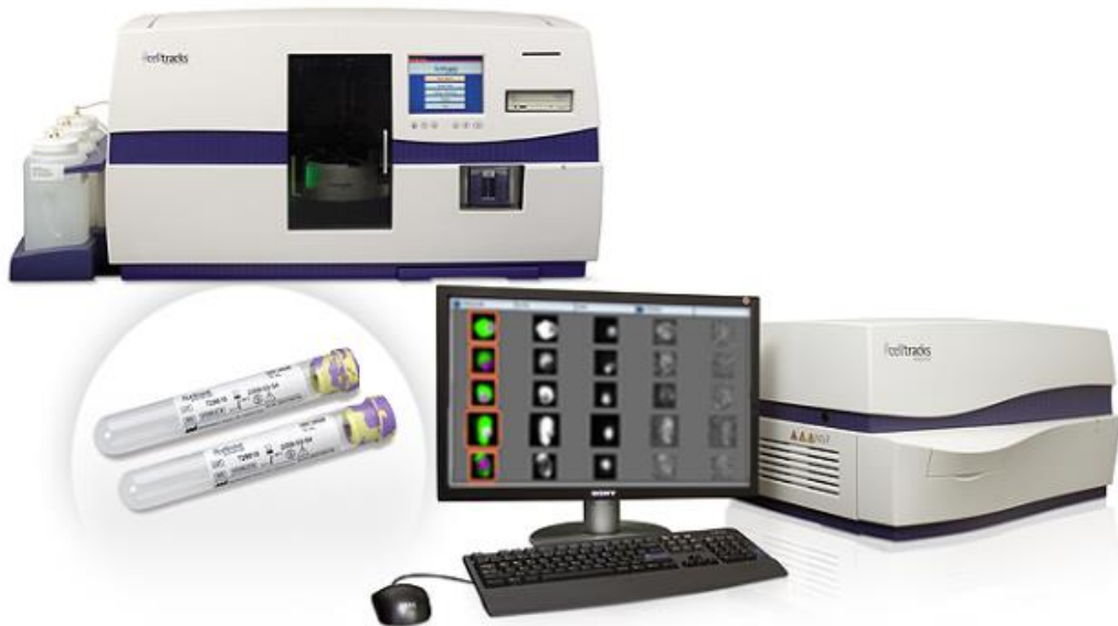
Slika 2. CellSearch@ uređaj za imunomagnetsku analizu cirkulirajućih tumorskih stanica.(preuzeto sa: www.cellsearch.com )
