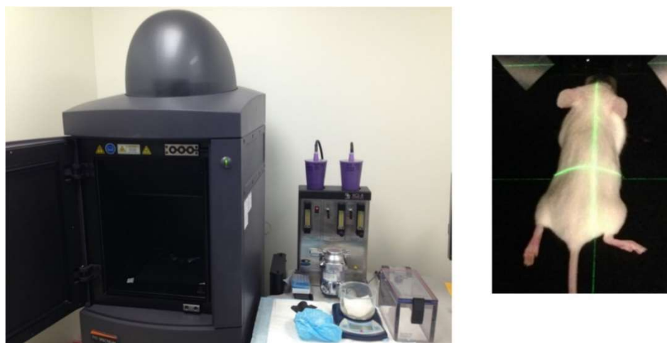
Slika 65. Uređaj za snimanje bioluminiscentnog signala in vivo (lijevo) i miš postavljen unutar uređaja (desno) (preuzeto i prilagođeno iz Carceles-Cordon i sur., 2016).
