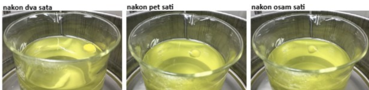
Slika 21. Proučavanje uzgona i plutajuće sposobnosti 50 % punjive plutajuće tablete nakon dva sata, pet i osam sati (prilagođeno prema literaturnom navodu (59)).
