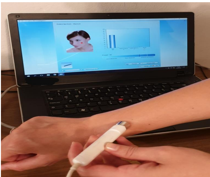
Slika 9. Mjerenje hidratacije kože korneometrom.
