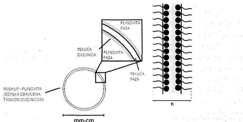
Slika 2. Slojevita struktura tekuće ovojnice; središnji vodenji odjeljak ovojnice (lamele) smješten je između dva postranična monosloja površinski aktivnih tvari (PAT); orijentacija PAT molekula sredstva za pjenjenje na površini otopina/plin i slojevita struktura tanke ovojnice tekućine debljine  $h$  10-1000 nm (prilagođeno prema ref. 4).
