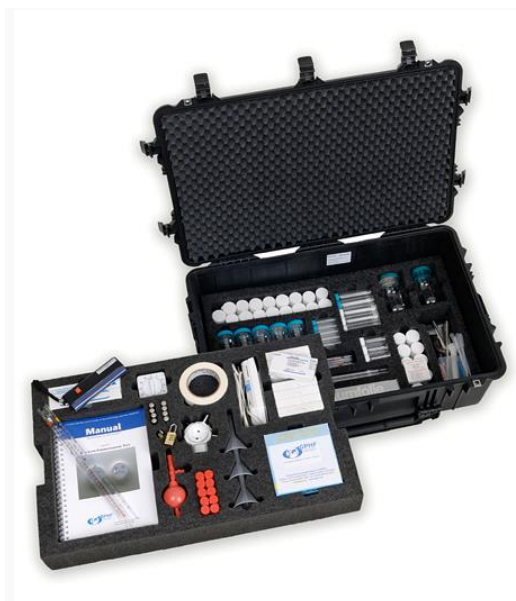
Slika 12 - Izgled GPHF Minilaba (preuzeto iz literaturnog navoda 36)
