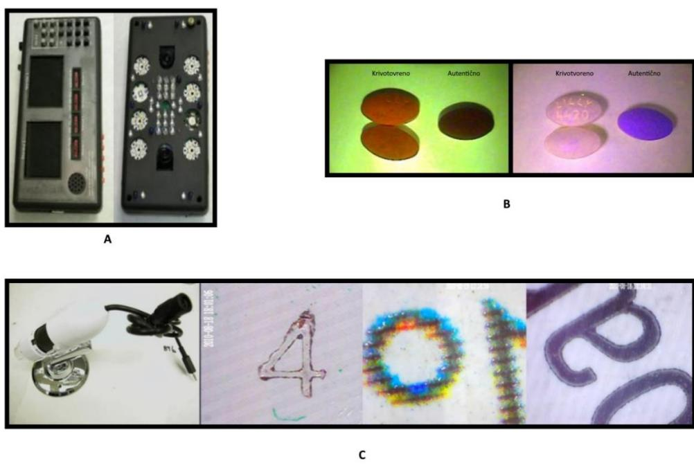
**Slika 11** - CD3+ uređaj i primjeri rezultata analize potencijalnih krivotvorina
