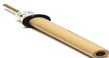
Slika 6. Elektroda od staklastog ugljika
