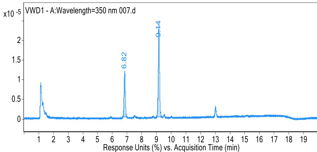
**Slika 44.** UV kromatogram inkubacijske smjese za 6-hidroksiflavon s dodanim generirajućim sustavom.
