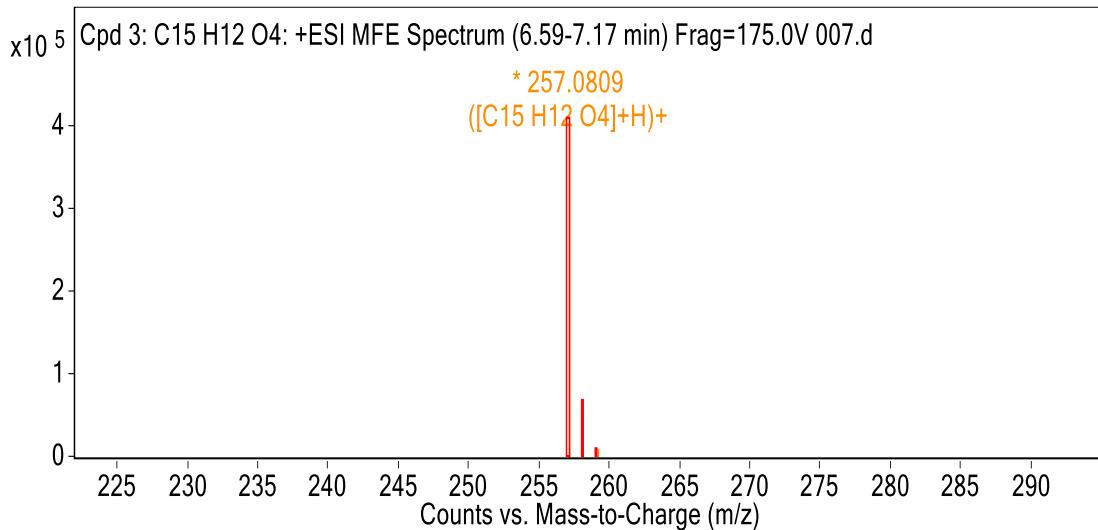
**Slika 46.** Spektar izdvojenog iona nepoznatog flavonoida ( $m/z = 257,0809$ ) inkubacijske smjese za 6-hidroksiflavon s dodanim generirajućim sustavom.
