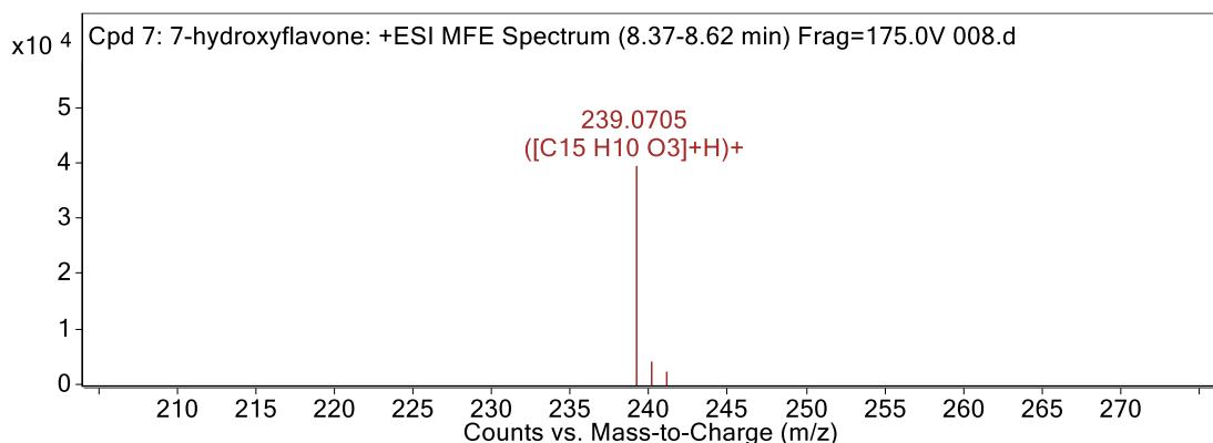
**Slika 27.** Spektar izdvojenog iona 7-hidroksiflavaona ( $m/z = 239.0705$ ) inkubacijske smjese za flavon s dodanim generirajućim sustavom.
