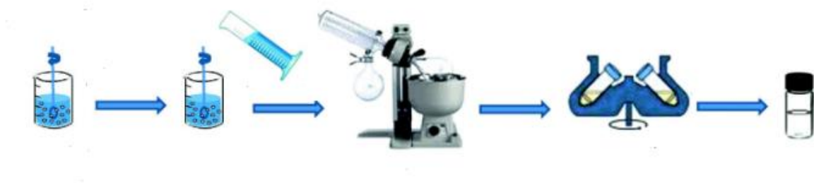
Slika 19: Metoda pripreme nanočestica (preuzeto iz: www.elsevier.es )
