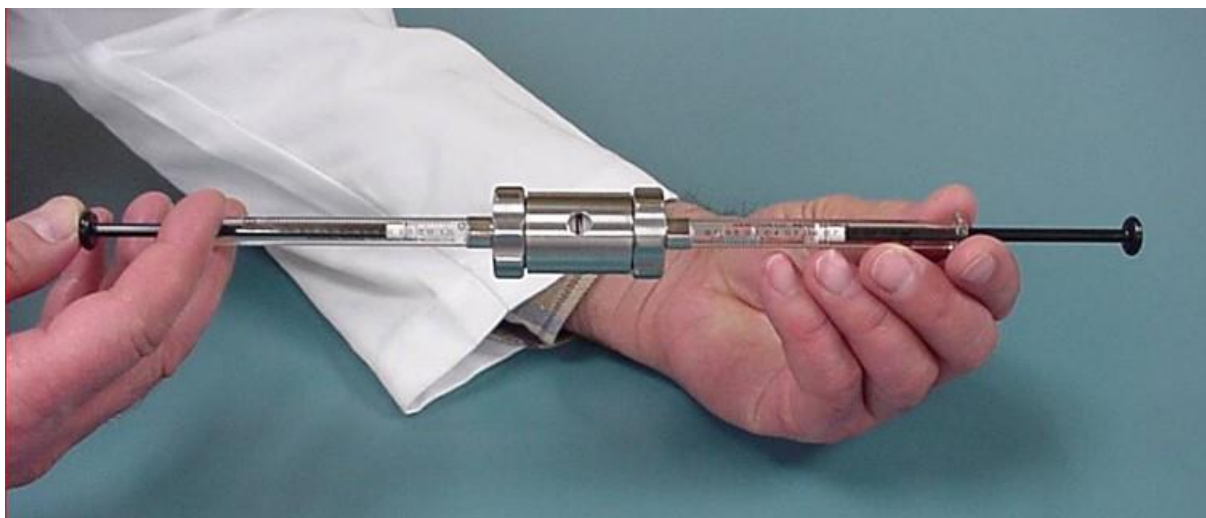
Slika 8. Ekstruzija liposomskih disperzija kroz polikarbonatne membranske filtere ( http://www.avestin.com )
