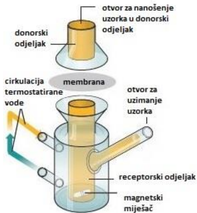
Slika 10. Franzova difuzijska ćelija (prilagođeno prema www.particlesciences.com )
