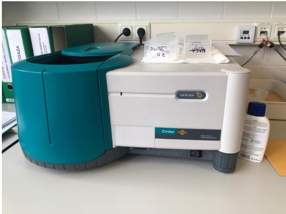
Slika 10. Varyan Carry Eclipse spektrofotometar
