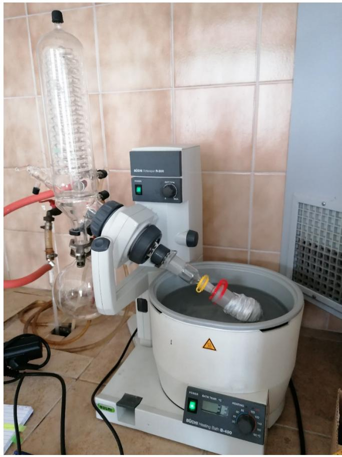
Slika 7. Postupak uparivanja na laboratorijskom rotacionom uparivaču,
