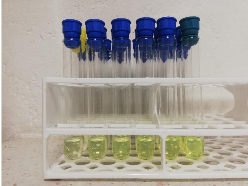
Slika 11. Koncentracijski niz standarda kvercetina nakon 15 minuta reakcije
