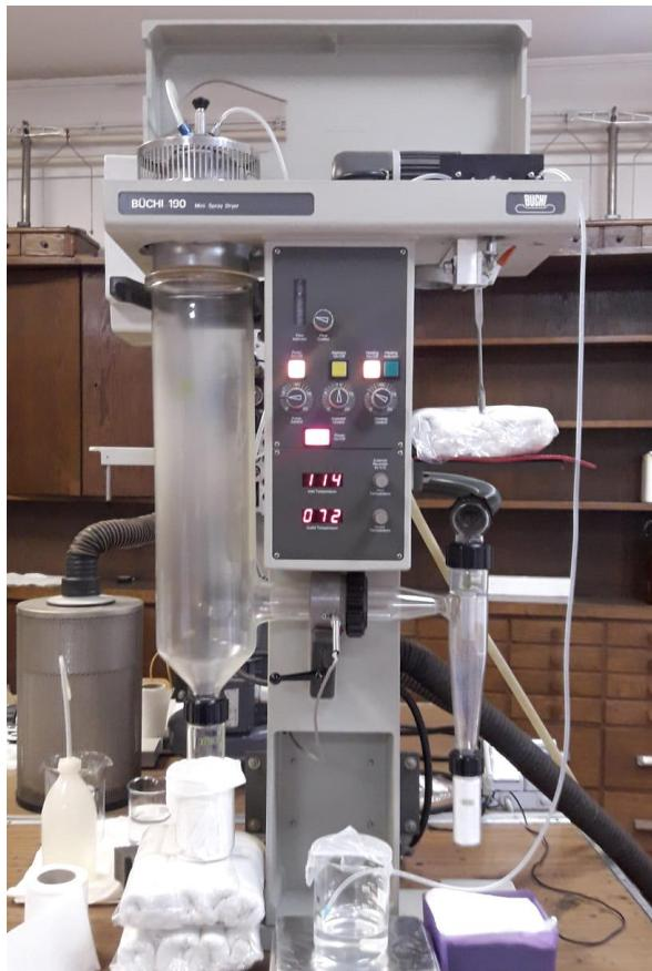
**Slika 10.** Uredaj za sušenje raspršivanjem Büchi 190 Mini SprayDryer
