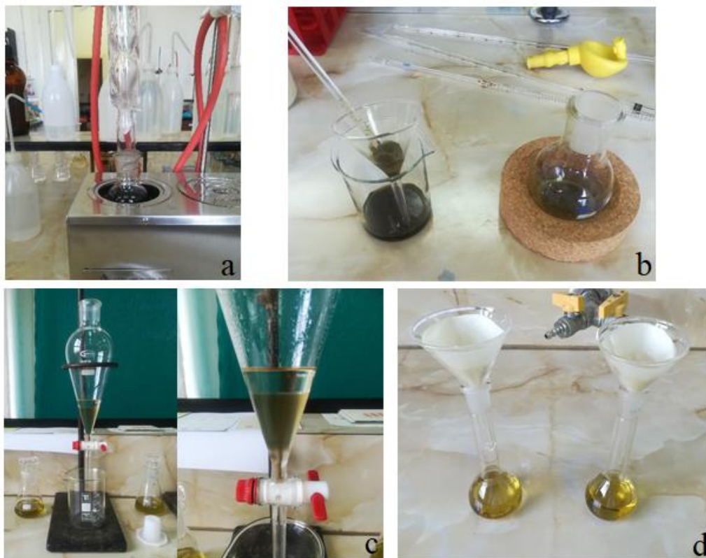
Slika 7. Određivanje flavonoida (a) ekstrakcija na vodenoj kupelji uz povratno hladilo (b) filtriranje preko pamuka (c) izmučkivanje s etilacetatom (d) filtriranje preko bezvodnog natrijevog sulfata
