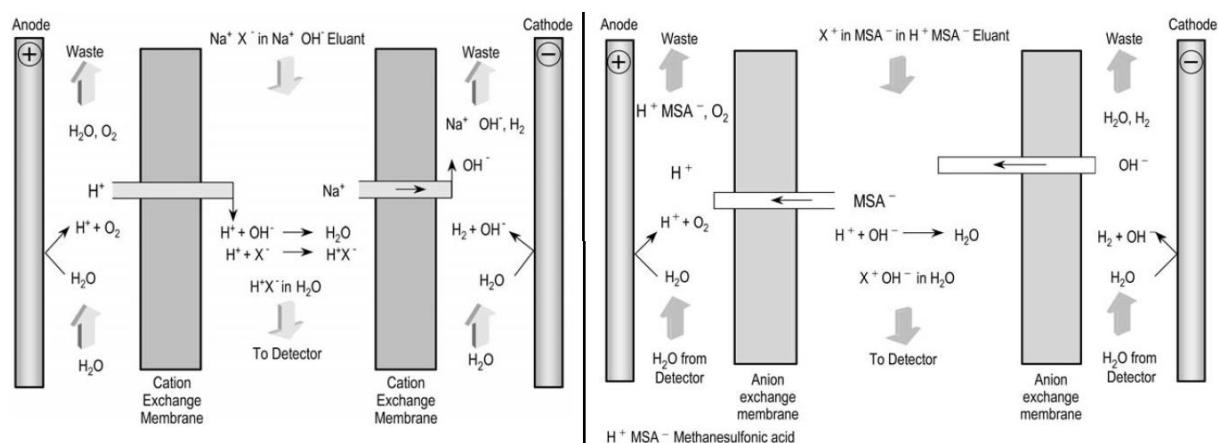
Slika 5: Mehanizam supresije u samo-regeneracijskom supresoru. (Weiss, 2004)
