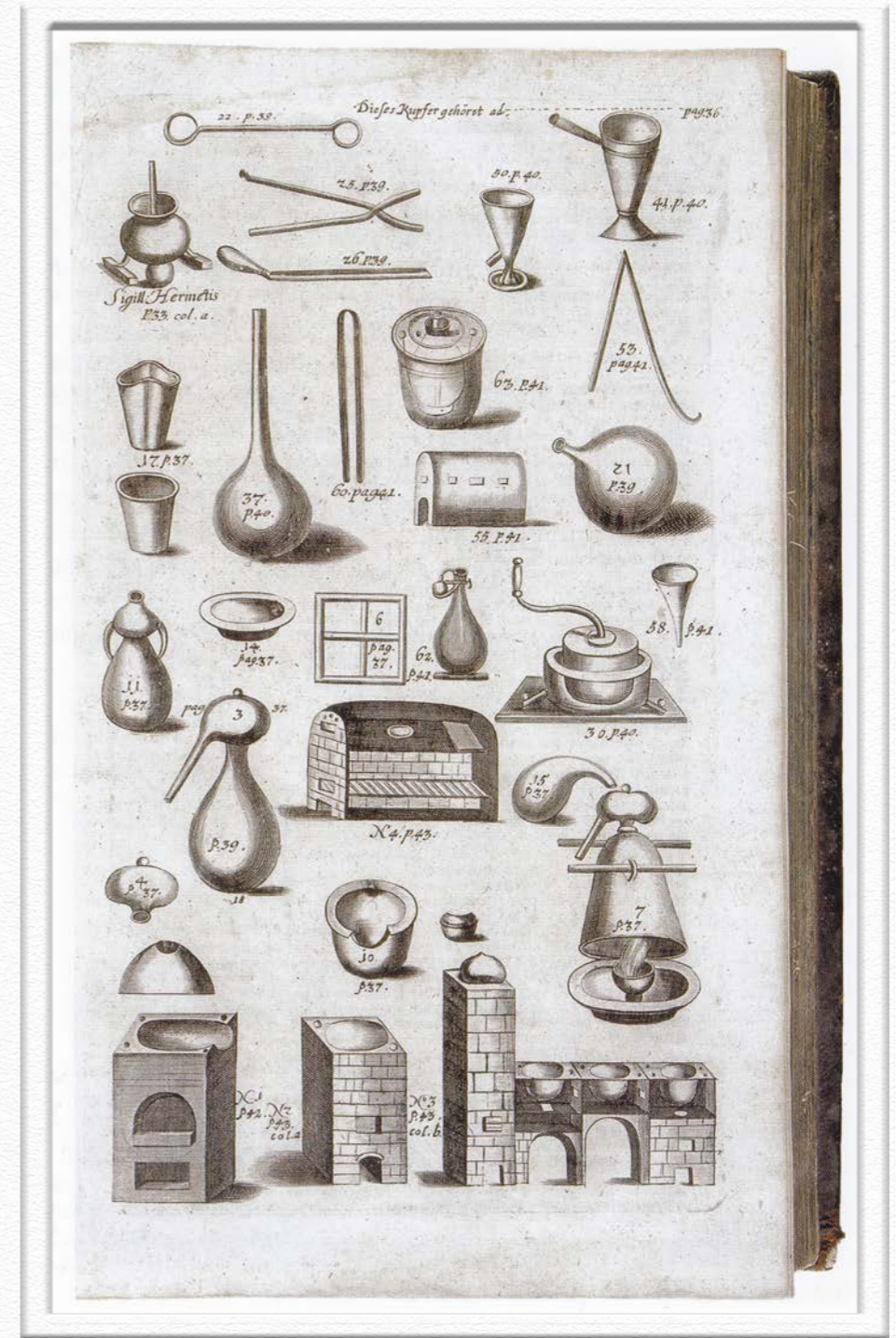
Ljekarnički pribor i naprave ljekarničkog laboratorija iz 18. stoljeća kao sastavni dio farmakopeja. Ljekarnički su laboratoriji dugo bili jedina mjesta gdje se uz farmaciju razvijala i kemijska znanost. (str. 576, 590)
