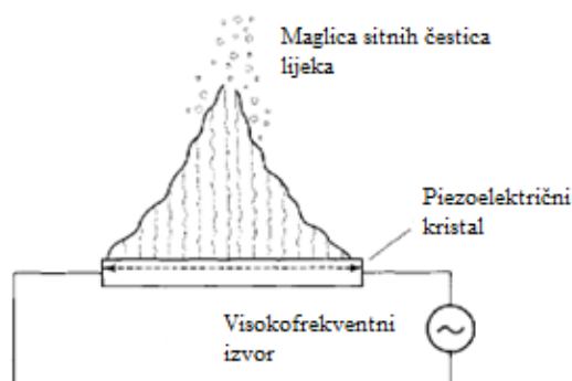
Slika 6. Shematski prikaz ultrazvučnog atomizatora (Atkins i sur., 1992.)
