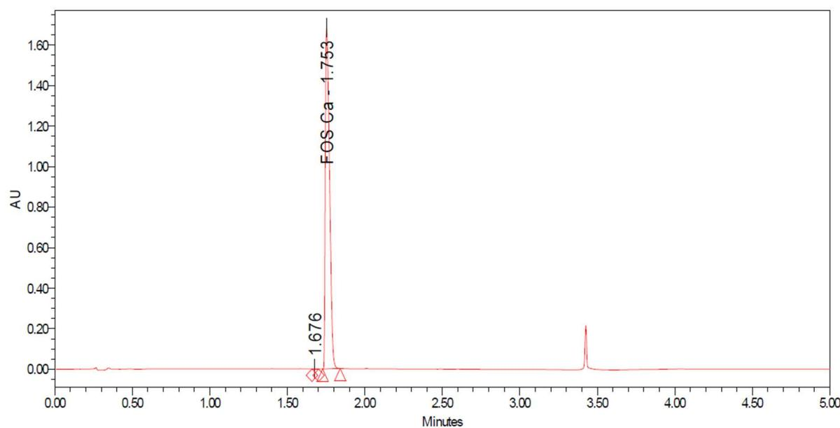
Slika 27 Kromatogram necijepljene otopine uzorka fosamprenavir kalcija
