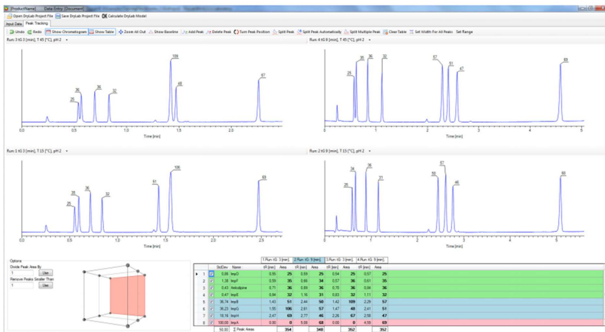
Slika 8. Praćenje pikova u DryLab® softveru
