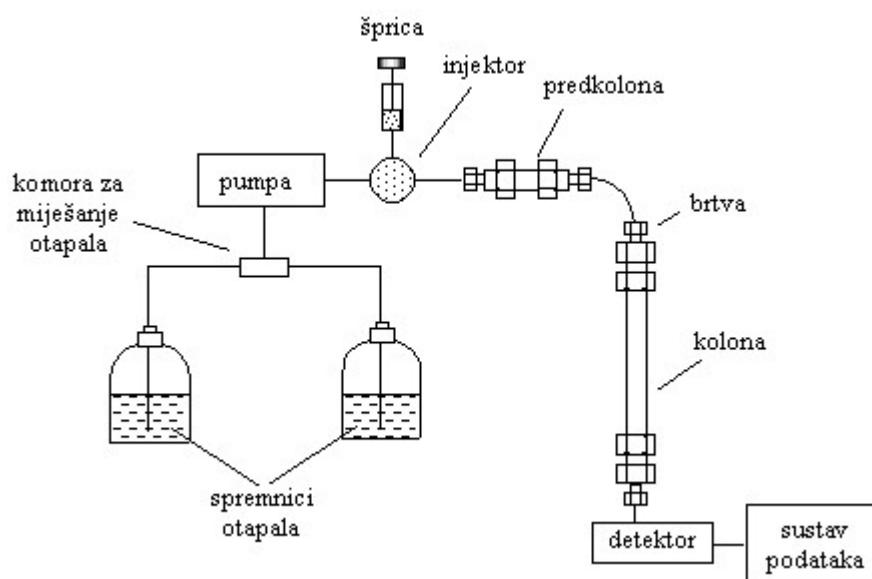
Slika 6. Shematski prikaz tekućinskog kromatografa visoke djelotvornosti
