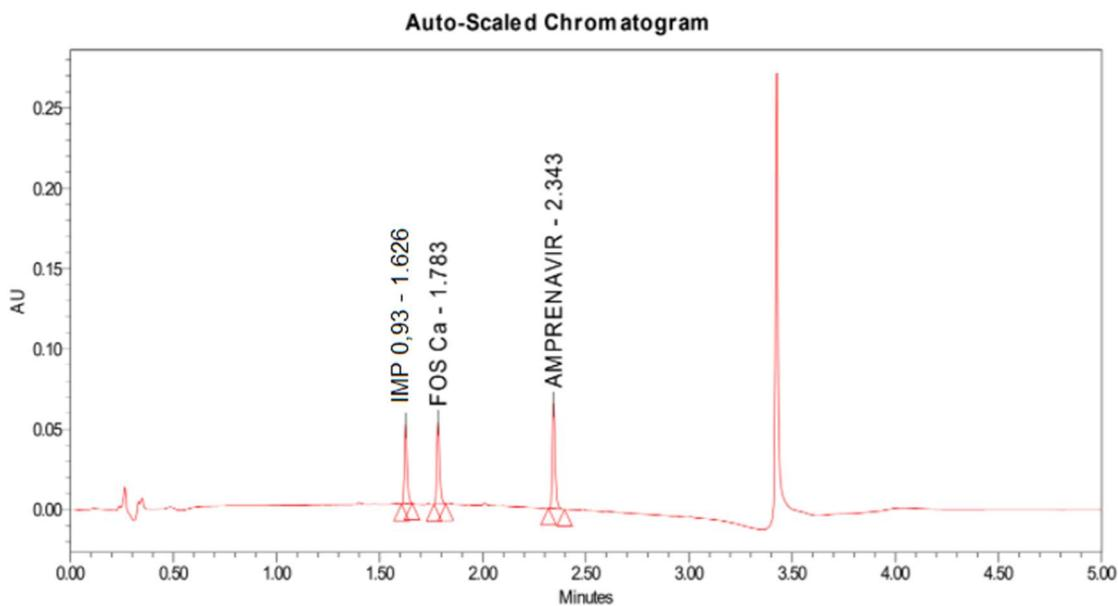
**Slika 30. Kromatogram otopine za određivanje granice kvantifikacije, otopina standarda fosamprenavir kalcija i njegovih onečišćenja masene koncentracije 0,0002 mg/mL (0,02% radne koncentracije uzorka)**
