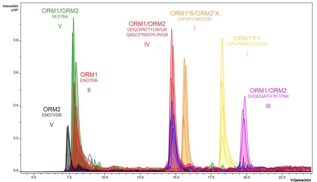
**Slika 5.** Kromatogram izoliranih iona (eng. Extracted ion chromatogram, EIC) za neke od najzastupljenijih glikana za svako glikozilacijsko mjesto i gensku varijantu. Pikovima karakterističnim za određeno vrijeme zadržavanja u istoj boji je nadodano od koje genske varijante potječe analizirani glikani tog glikozilacijskog mjeseta te peptidni slijed na kojem se nalaze. Za označavanje glikozilacijskih mjesta korišteni su rimski brojevi.
