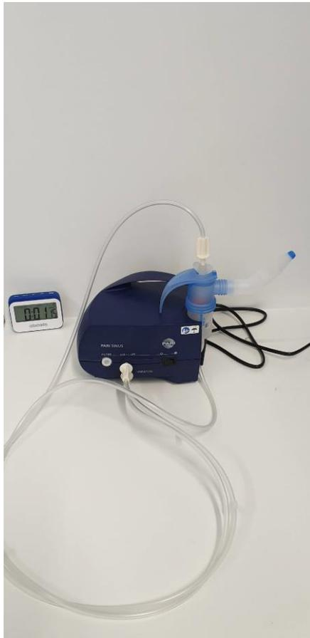
**Slika 7.** Nebulizator Pari Sinus<sup>TM</sup> pripremljen za ispitivanje ujednačenosti doziranja *in situ* gelirajućih nanosuspenzija flutikazonpropionata
