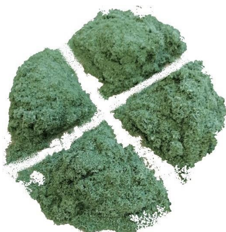
Slika 9. Homogenizacija uzorka lista masline metodom četvrtanja.
