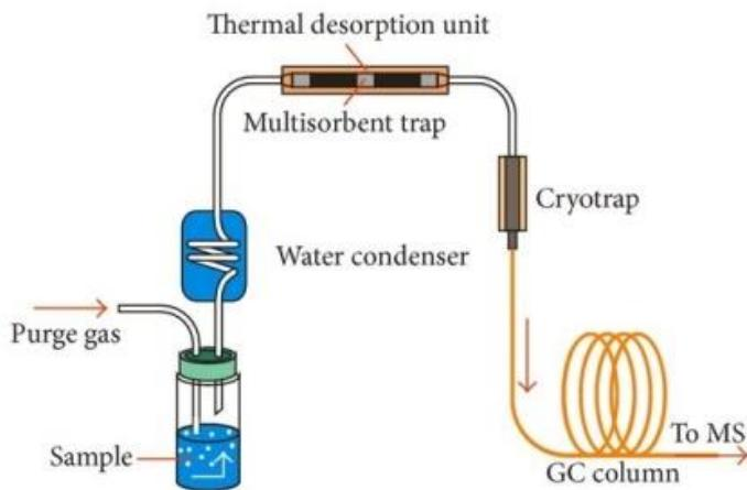
Slika 3. Shematski prikaz dinamičkog *headspace* uzorkovanja (<https://www.researchgate.net/>)
