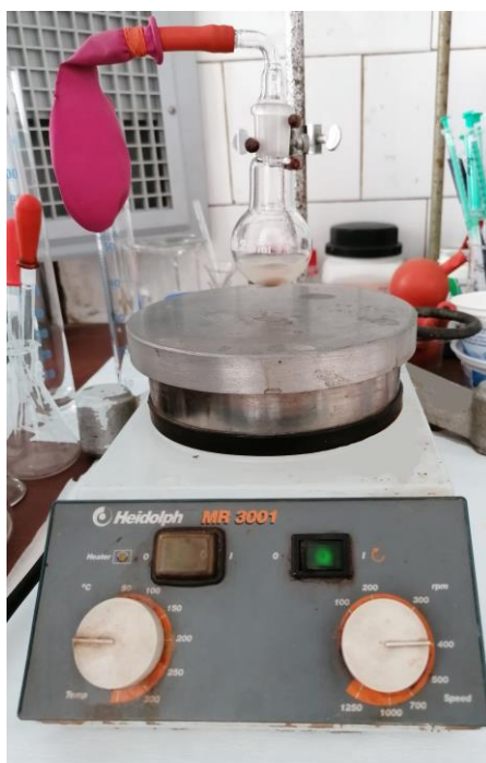
Slika 8. Aparatura za pripravu ferocenoilne nukleoaze. U tikvici se nalazi reakcijska smjesa koja sadrži 6-benziloksipurin aktiviran bazom NaH u DMF-u prije dodatka kiselinskog klorida. Reakcijska smjesa miješa se magnetskom miješalicom, iznad koje je i smještena tikvica.
