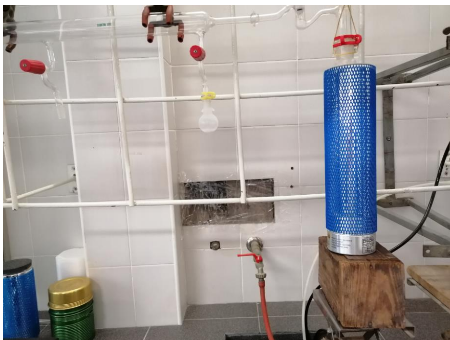
Slika 13. Dio aparature za otplinjavanje. Desno je hladna stupica uronjena u Dewarovu posudu punjenu tekućim dušikom. Lijevo od nje je staklena tikvica u kojoj je skrutnuto otapalo priključena na stakleni razdjelnik. Pumpa se nalazi desno od hladne stupice.
