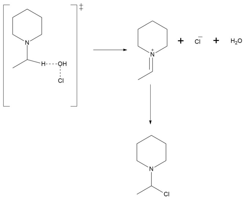
Shema 6: Reakcija  $C_2$ -dehidracije vanjskog ugljika N-etilpiperidina
