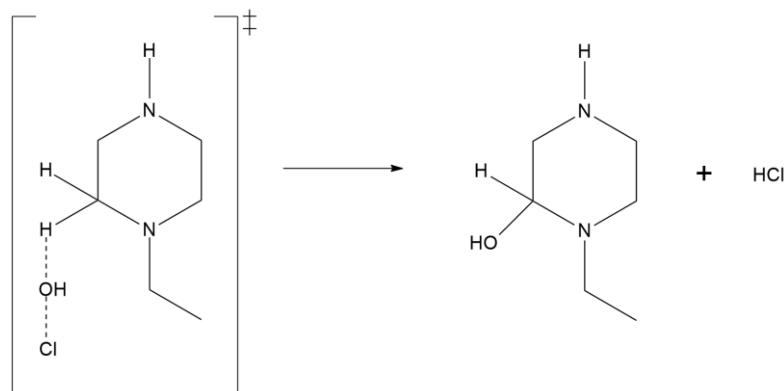
Shema 8: Reakcija C<sub>2</sub>-hidroksilacije N-etilpiperazina
