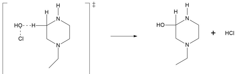
Shema 9: Reakcija C<sub>3</sub>-hidroksilacije N-ethylpiperazina
