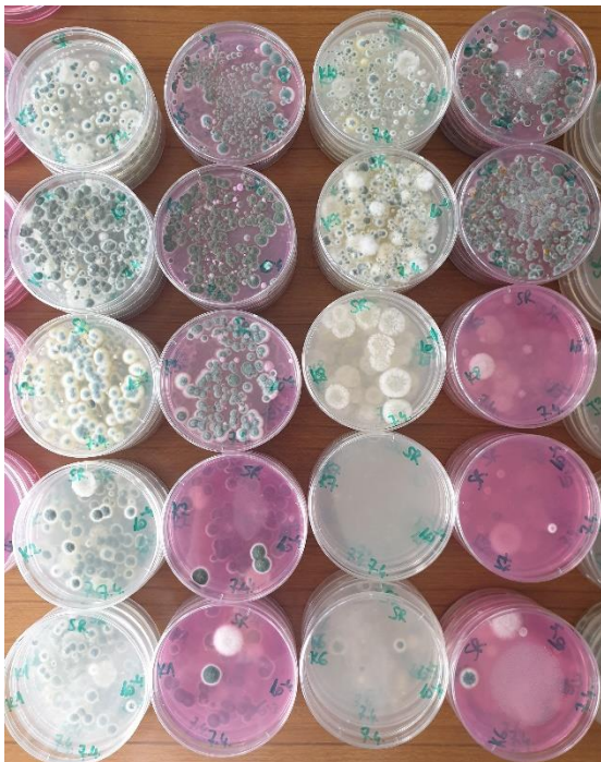
Slika 3. Primjer brojanja kolonija plijesni na DG-18 i DRBC hranjivoj podlozi nakon inkubacije (7 dana, 25 °C). Odbacivanje ploča na kojima se razvilo više od 150 kolonija.
