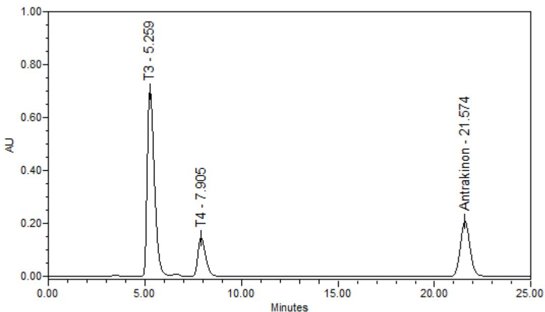
*Slika 10. Reprezentativni kromatogram istovremene analize standarda T3 (100 µg/mL), T4 (100 µg/mL) i antrakinona (100 µg/mL).*
