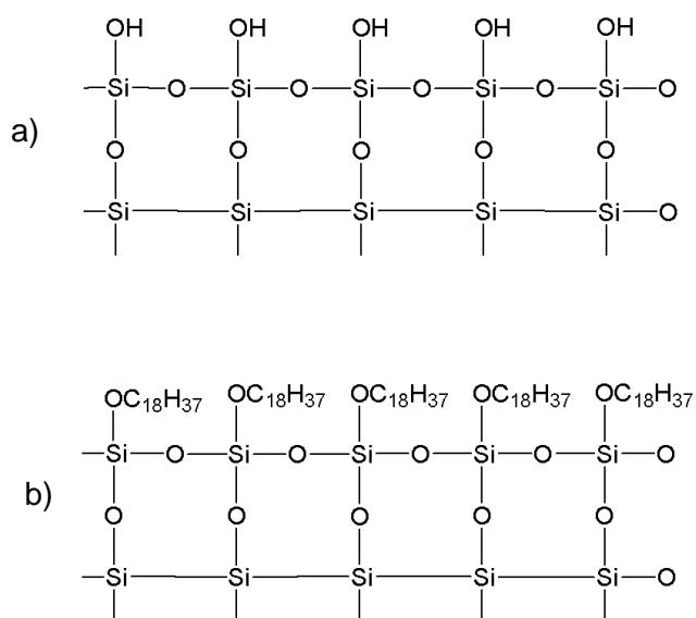
*Slika 6. Shematski prikaz strukture normalne, polare (a) i obrnute, nepolare (b) stacionarne faze (preuzeto iz: Skoog i sur., 2016).*
