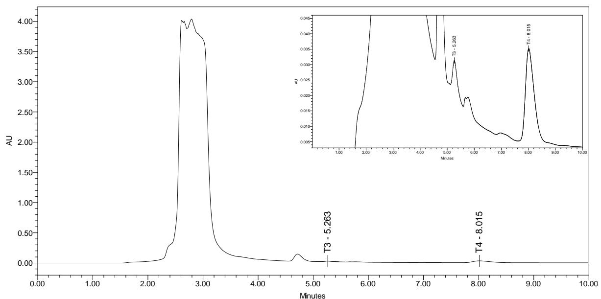
Slika 13. Kromatogram hidrolizata komercijalnog tiroidnog pripravka u roku trajnja, uzorak 1.
