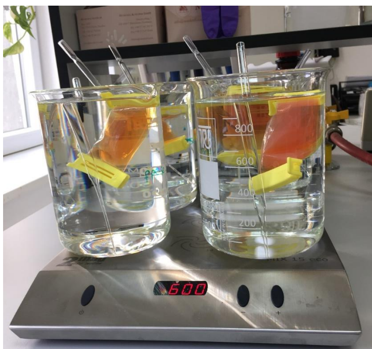
Slika 3. Čišćenje novosintetiziranih otopina nanoselena dijalizom.
