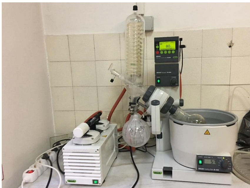
Slika 6. Uparavanje uzorka na rotavaporu
