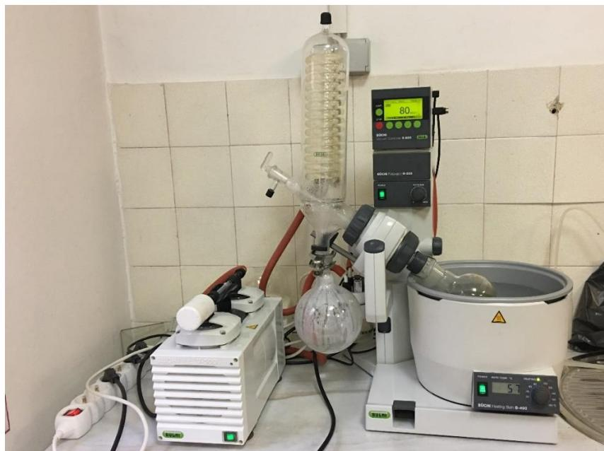
Slika 6. Uparavanje uzorka na rotavaporu
