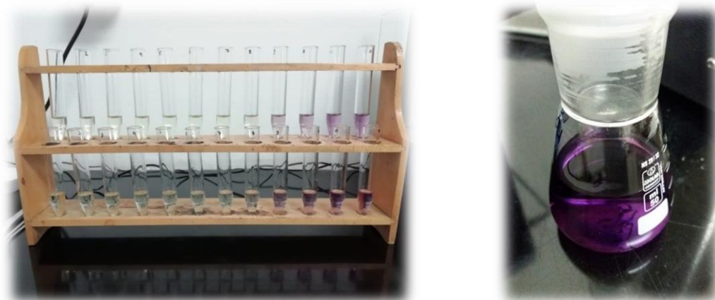
Slika 14. Određivanje sposobnosti hvatanja DPPH slobodnog radikala
