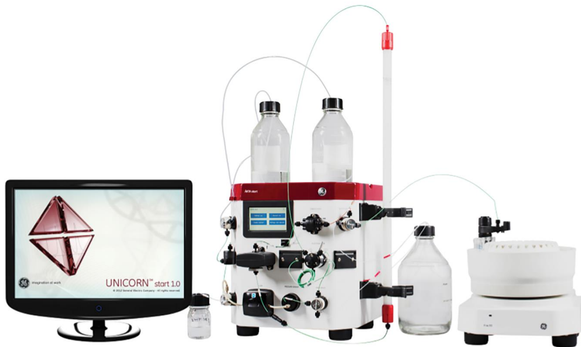
Slika 3. Prikaz ÄKTA™ Start sistema.
