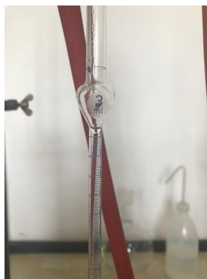
Slika 7. Graduirana cijev s eteričnim uljem
