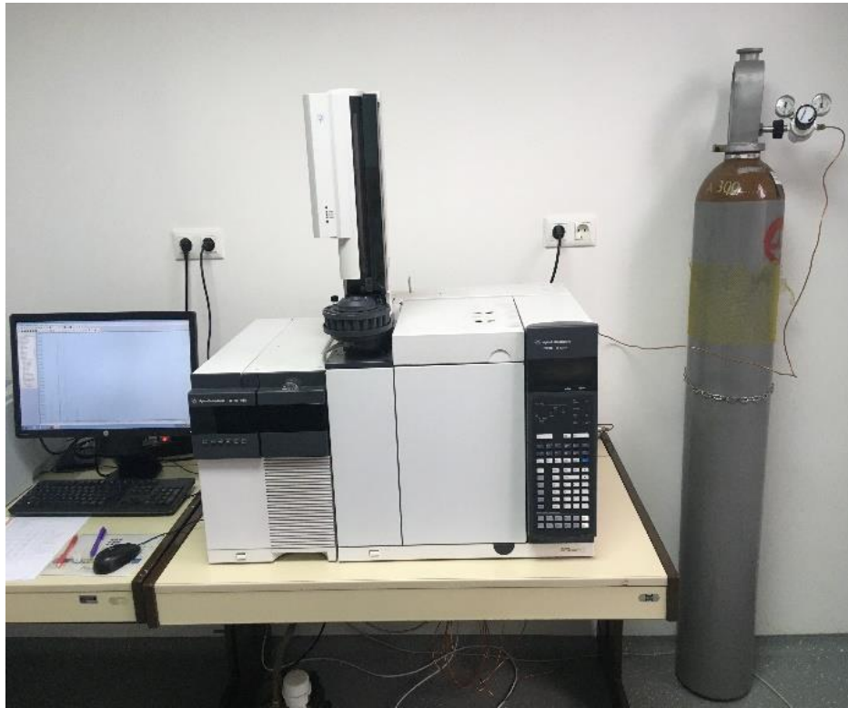
Slika 8. Spregnuti sustav plinske kromatografije sa spektrometrijom masa u kojem je napravljena analiza eteričnog ulja (Zavod za farmakognoziju Farmaceutsko-biokemijskog fakulteta)
