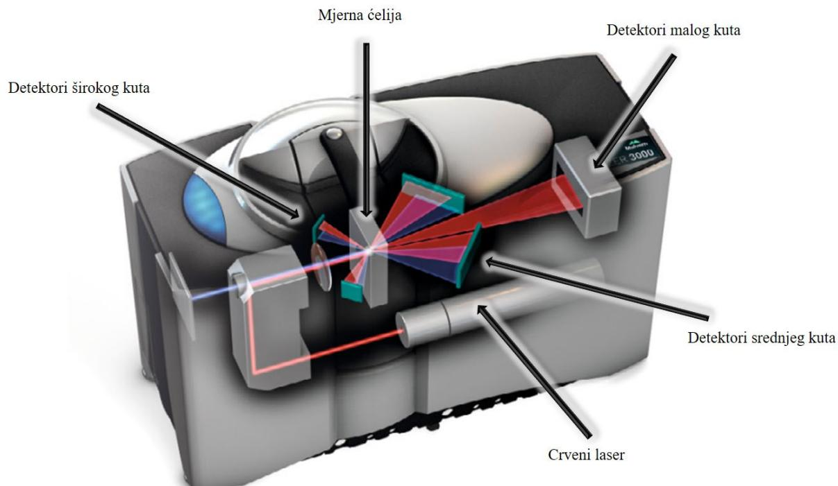
**Slika 13:** Raspored optičkih dijelova Malvernovog instrumenta za lasersku difrakciju (preuzeto s [www.malvern.com](http://www.malvern.com))
