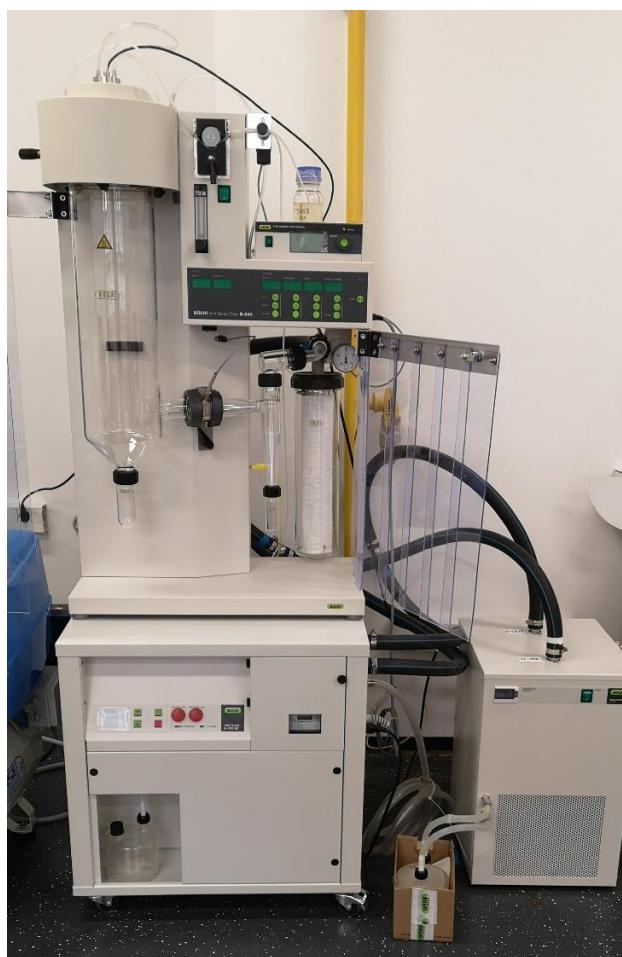
**Slika 3.** Büchi Mini Spray Drier B-290 s odvlaživačem
