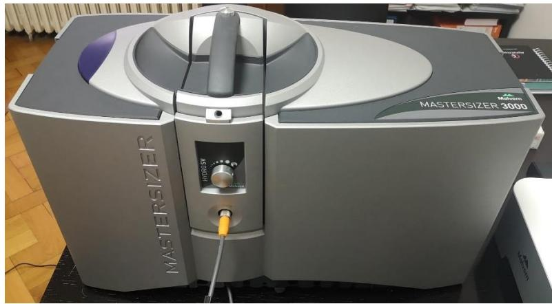
**Slika 4.** Mastersizer 3000 opremljen Hydro SV čelijom
