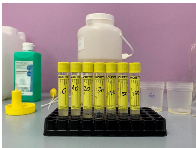
Slika 2 Uzorci mokraće točno određenih koncentracija glukoze
