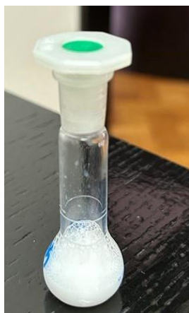
Slika 12. 1 % nanosuspenzija loteprednol etabonata u 1 % otopini SoluPlus® nakon 24 sata vlažnog mljevenja.
