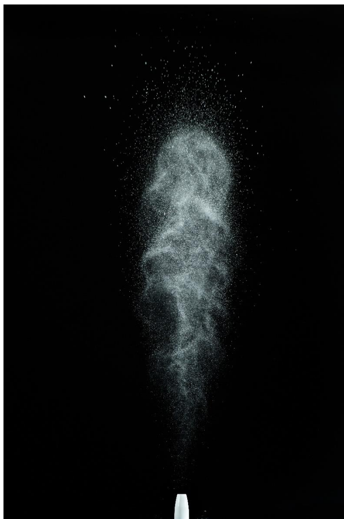
Slika 13. Fotografija raspršivanja praška iz monodozirnog uređaja UDS Powder naspram tamne pozadine.
