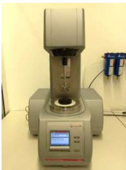
Slika 8. Reometar MCR 102 (Anton Paar GmbH, Austrija)
