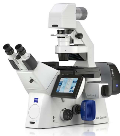
Slika 2. Primjer fluorescentnog mikroskopa (preuzeto s https://www.zeiss.com/ ).
